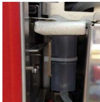
④シリングにハイドロクリーンを2ml入れ、チャンバー下部のチューブに接続し、
