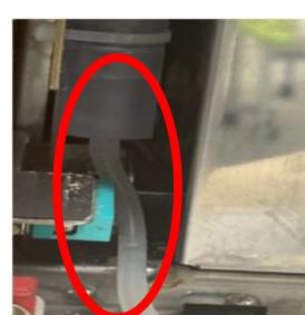
※シリングを押し込む際に抵抗がある場合はチャンバーの真下のチューブに接続されているかご確認下さい。
