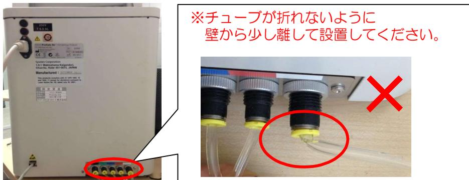
2.試薬キットに接続されているチューブを確認します。
