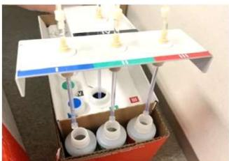
▲空気を充填しチューブ内に残っている試薬を抜きます。
